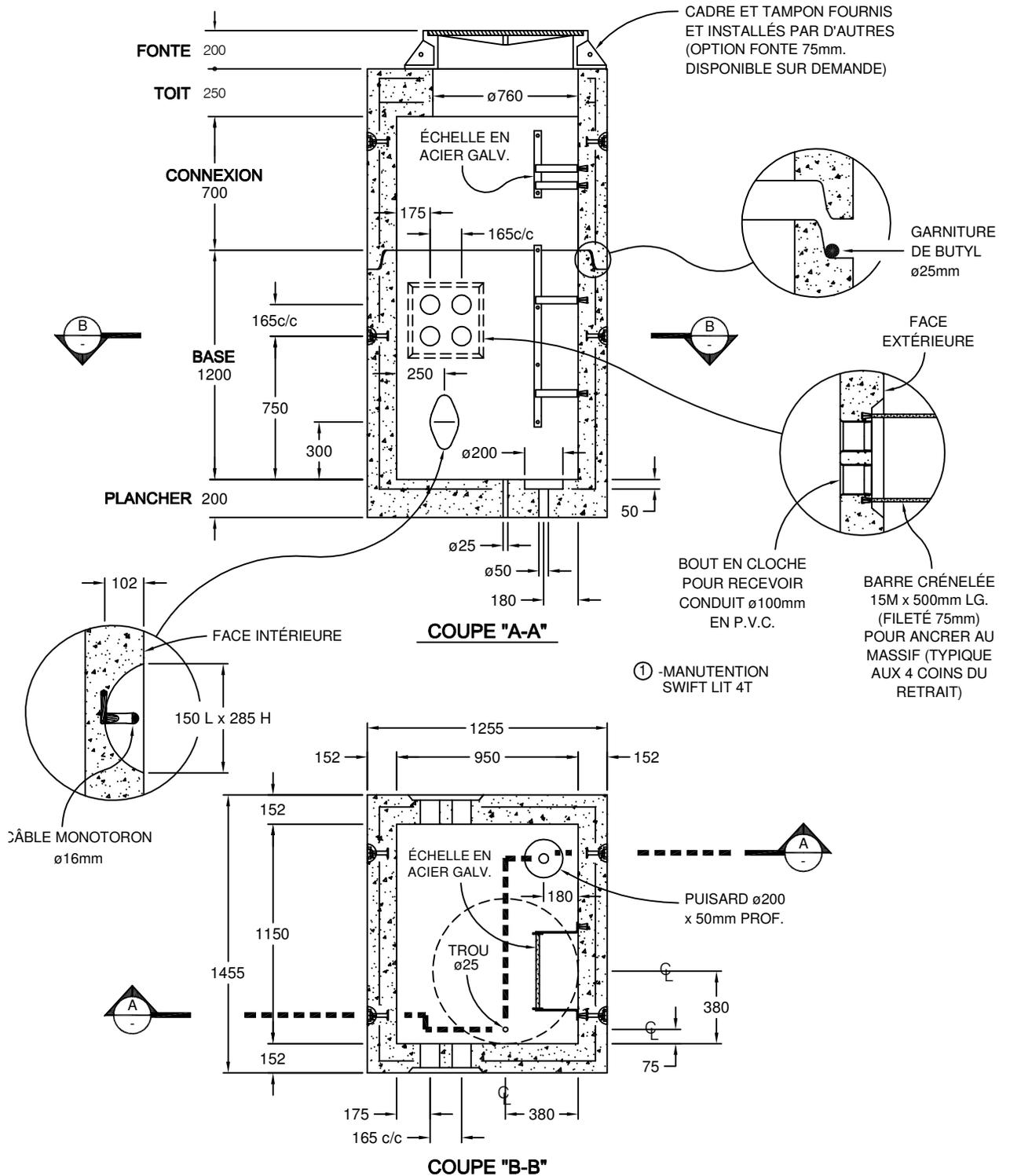
Regard préfabriqué en béton armé conforme aux normes:
